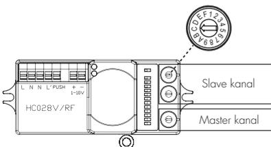
Slave und Master können bis zu 16 unterschiedliche Kanäle eingestellt werden (im Hexadezimal system)
